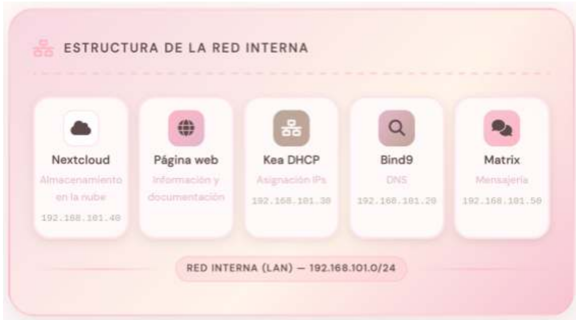
Figura 9. Estructura de la red interna
